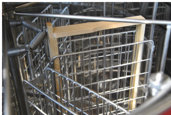
Рис.1 правильное расположение рамок в медогонке
