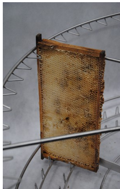
Рис.2 Правильное расположение рамки в Радиальной корзине
