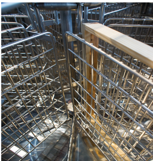
Фото 1 Правильное уложение рамок в кассетной медогонке
