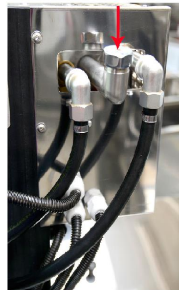
Фото 18 Место, где находится кран для емкости с жидкостью.
