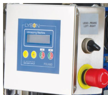
Фото 19 Аварийная кнопка «СТОП» А
