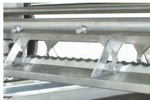
Фото 12 Регуляция верхних и нижних направляющих и правильная укладка рамок в них.
