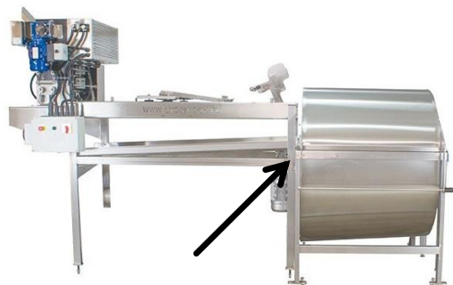
Фото 3. Монтаж податчика к медогонке и распечатки
