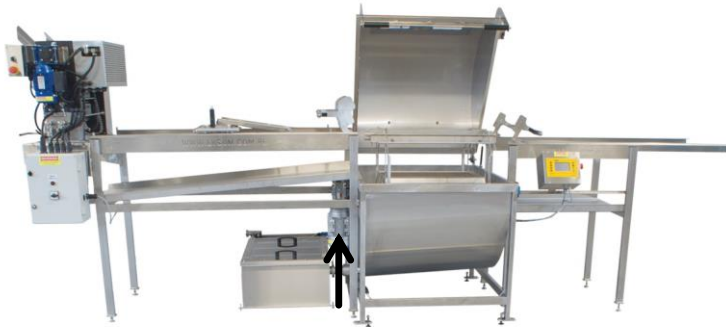
Фото 7. Линия с распечаткой и утепленным ситом.
