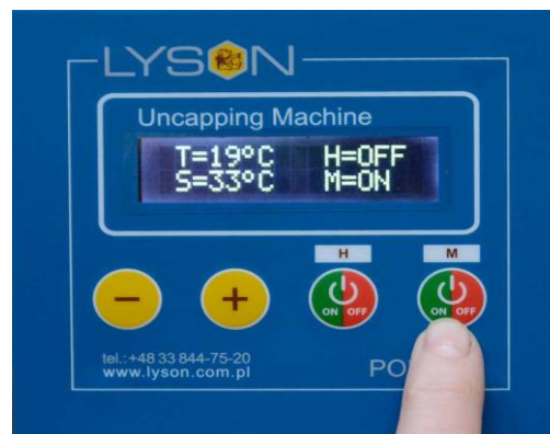
Фото 7 После выключения грелок на блоке управления появится коммуникат „OFF” и графический символ исчезнет.
