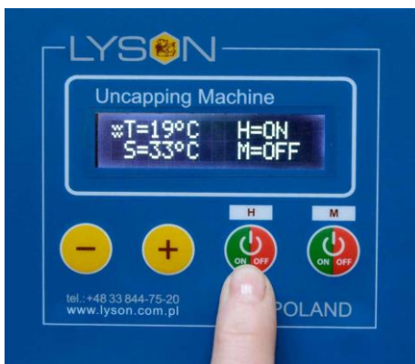
Фото 7 После выключения грелок на блоке управления появится коммуникат „OFF” и графический символ исчезнет.
