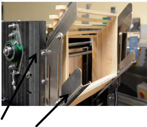
Фото 12 Регуляция верхних и нижних направляющих и правильная укладка рамок в них.
