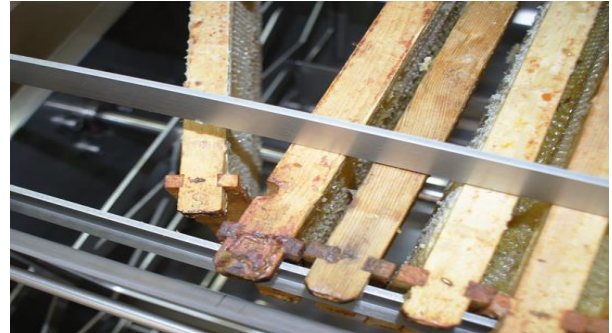
Фото 5. Неправильная, неполная укладка рамок в корзине.
