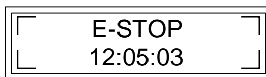
Рис 2. Состояние активации петли безопасности.
