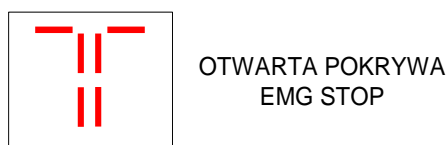
Рис. 4 Открыта крышка воскотопки, нажата аварийная кнопка СТОП (EMG STOP)
