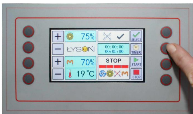
Фото 6 Установка времени работы оборудования (таймер)
