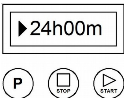
Рис. 2. В зависимости от установок на экране появится предварительно установленное время работы кремовалки.
